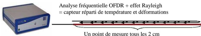
*Figure 17. Un système OFDR Rayleigh. Caractéristiques : résolution spatiale 2 cm, résolution en température  $\sim 0,1^{\circ}\text{C}$ , plage de mesure [0 K ; centaines de degrés], résolution en déformations  $\pm 1 \mu\text{m/m}$ , plage en déformations : 1,7 %, temps de balayage  $\sim 10$  s, post-traitement : plusieurs min, portée 70 m à 2 km par tronçons*
