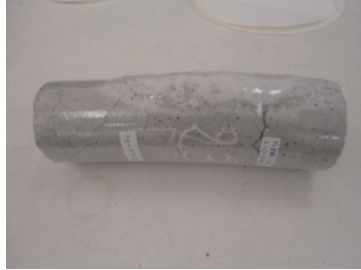
Figure 7. Éprouvettes écaillées avant l'essai d'écrasement à la machine
