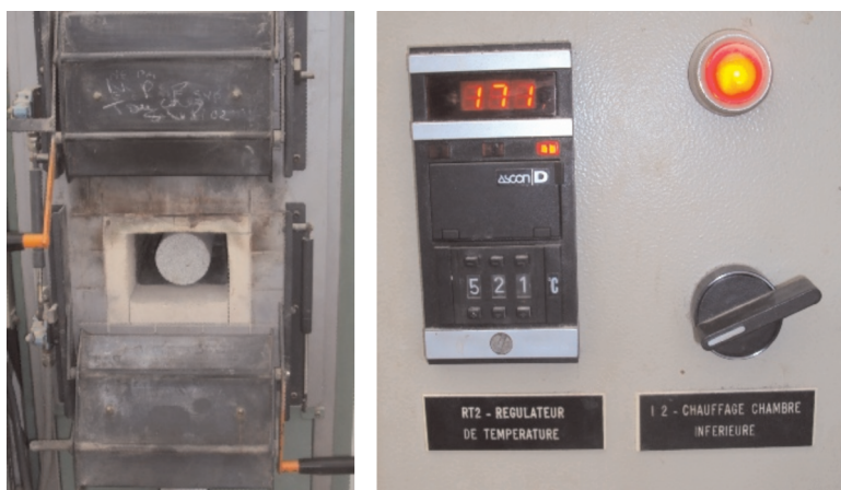
Figure 3. Four utilisé pour le chauffage des éprouvettes : chambres de chauffage du four ELTI 1000 °C (à gauche)/tableau de commande du four (à droite)
