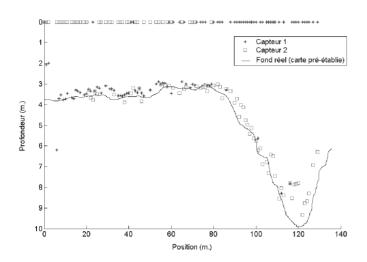
Figure 21. – Comparaison des acquisitions bathymétriques avec les profondeurs réelles.
