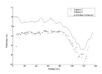
Figure 20. - Trajectoire du véhicule et données bathymétriques perçues.
