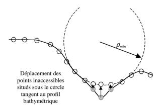
Figure 11. - Traitement d'un creux.
