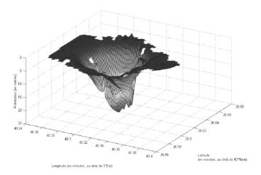
Figure 19. - Relevé bathymétrique de la source de La Vise.
