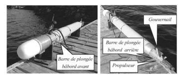
Figure 2. – Disposition des actionneurs de Taipan.
