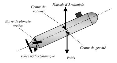
Figure 7. - Une partie des forces exercées sur le véhicule.
