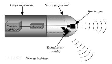
Figure 4. - Orientation des sondeurs.
