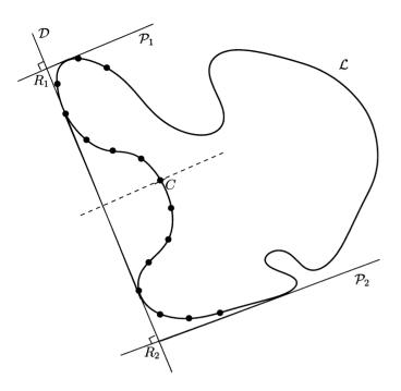
Figure 2. – Codage similitude invariant d'un morceau de ligne de niveau. Ici N=15 et F=2; la direction utilisée pour le codage est celle d'une bitangente. Les coordonnées des points marqués dans le repère orthonormé s'appuyant sur  $[R_1,R_2]$  forment le code d'un morceau de courbe.
