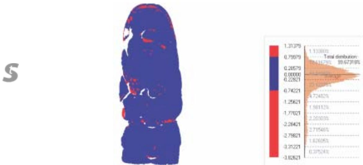
Figure 6. Carte des distances entre le nuage reconstruit et celui du scanner.
