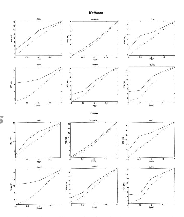
Figure 4. RSR en dB moyen sur 100 simulations en fonction du facteur d'échelle  $\rho$  pour les images des intensités de Hoffman et de Lena. Les 6 premiers graphes comparent les transformations de Fisz (trait continu) et d'Anscombe (trait discontinu) pour chaque débruiteur. Dans les deux derniers graphes, nous comparons tous les débruiteurs pour chacune des deux transformations.
