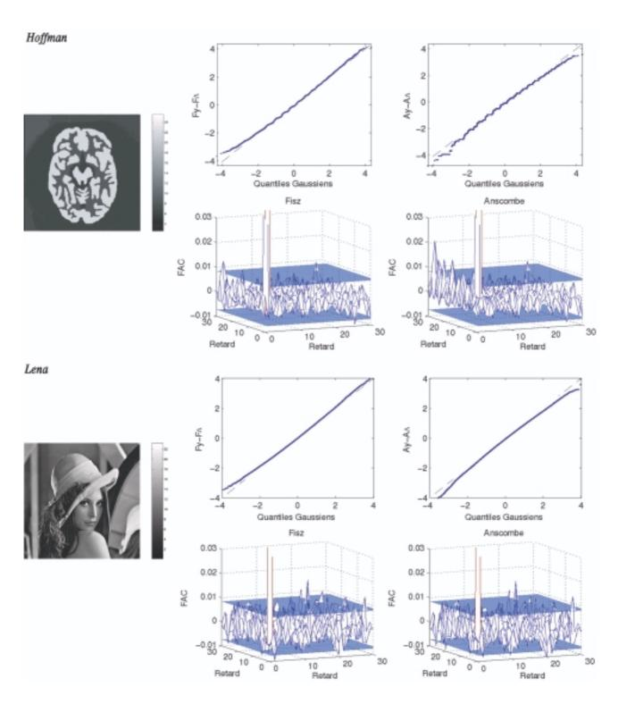
Figure 1. Comparaison des transformations de Fisz et d'Anscombe sur du bruit Poissonien simulé à partir de deux images des intensités, l'une du fantôme de Hoffman et l'autre de Lena. Pour chaque image, les graphes des quantiles sont sur la 1<sup>re</sup> ligne et les FACS sur la 2<sup>e</sup> ligne. Les plans horizontaux sur les FACs correspondent aux limites de Barlett à 5 %.
