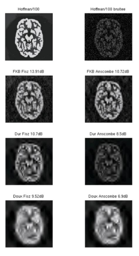
Figure 3. Exemple d'application des transformées de Fisz (colonne 1) et d'Anscombe (colonne 2) avec les débruiteurs bayésien FKB et universel avec seuillages dur et doux. L'image de Hoffman bruitée est contaminée par un bruit de Poisson après avoir divisé l'image des intensités par 100 (très faible taux de comptage). Les valeurs du RSR sont aussi portés au dessus de chaque image.
