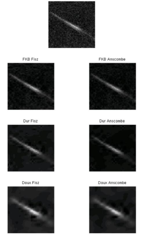
Figure 5. Comparaison des transformations de Fisz et d'Anscombe avec divers débruiteurs sur une image réelle d'un défaut obtenue par imagerie magnéto-optique. La première image est l'image des comptages originale. Les autres correspondent aux résultats après transformation de Fisz ou d'Anscombe, débruitage (FKB, seillages dur ou doux) puis transformation inverse.
