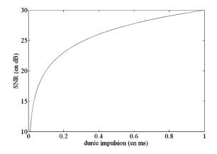
Figure 10. Rapport Signal/Bruit en fonction de la durée d'émission du ping.
