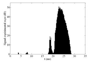
Figure 12. Simulation (en haut) et expérimentation (en bas) de l'écho d'un fond incliné de 21°.
