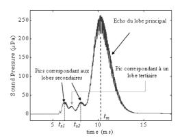
Figure 6. Les trois lobes du faisceau diffracté d'un transducteur carré et la simulation de l'enveloppe des échos acoustiques correspondants.
