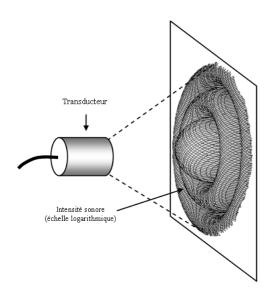
Figure 2. Intensité du faisceau émis par un transducteur à ouverture circulaire.
