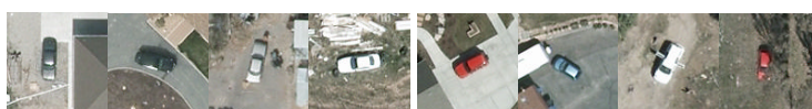
Figure 6. Régions de 100 \times 100 pixels centrées sur des voitures (base VeDAI). La taille, les reflets spéculaires, les ombres et occultations rendent la tâche de détection difficile
