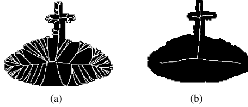
Figure 3. Mise en évidence de la problématique liée aux déformations des frontières de la forme. En (a), axe médian obtenu à partir du Integer Medial Axis (IMA) (Hesselink, 2007), une méthode n'intégrant pas de processus d'élagage (suppression des branches parasites). En (b), la même image soumise au DMA pour une valeur du paramètre \delta optimisée
