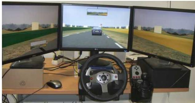
Figure 4. Dispositif du simulateur de conduite (avec 3 écrans, volant, boîte de vitesse et pédalier) utilisant le simulateur de trafic routier *ARCHISIM*
