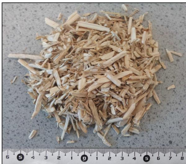
Figure 1. Granulat de chanvre utilisé
