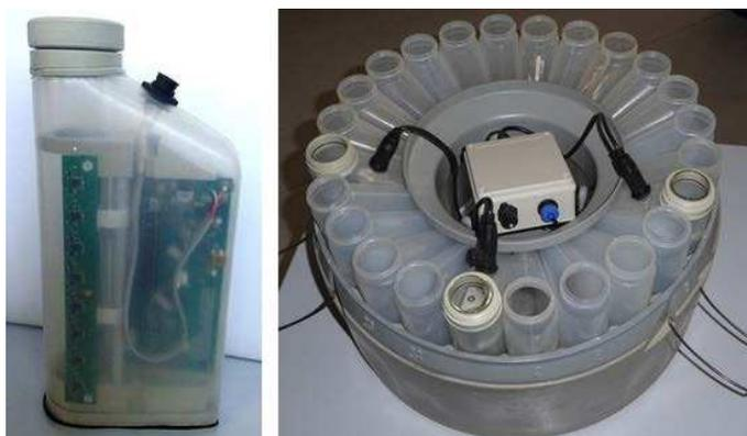
Figure 4. a) Flacon instrumenté, b) base de préleveur dotée de flacons instrumentés et de l'interface CAN-USB
