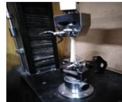
**Figure 7.** Universal tensile tester
