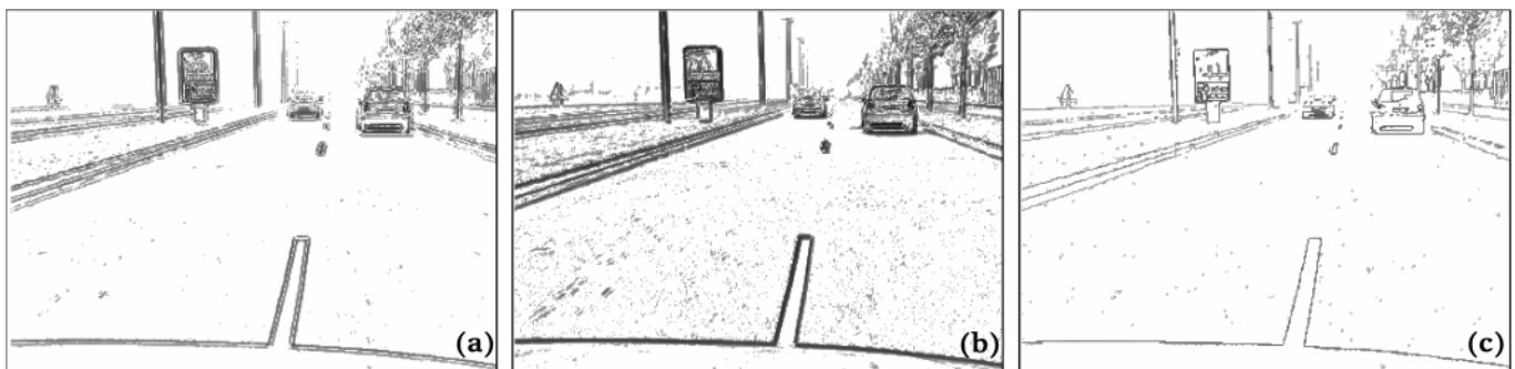
Figure 4. Exemple de contraste calculé par (a) méthode de Gordon (b) Beghdadi (c) méthode modifiée de Köhler.
