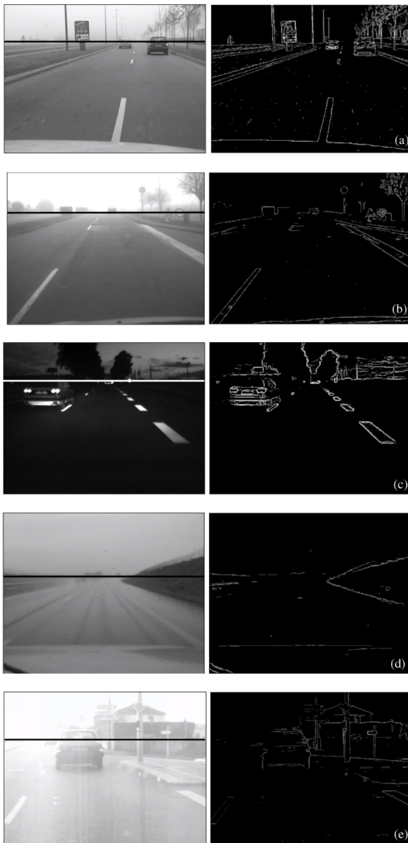
Figure 15. Gauche : image originale et ligne horizontale représentative de la distance de visibilité mobilisée. Droite : primitives de contraste au sens de Weber supérieur à 5 % (a) Brouillard léger ( V_{mob} \approx 200\text{ m} ), (b) brouillard dense ( V_{mob} \approx 50\text{ m} ), (c) nuit ( V_{mob} \approx 250\text{ m} ), (d) pluie forte ( V_{mob} \approx 60\text{ m} ), (e) éblouissement ( V_{mob} \approx 40\text{ m} ).
