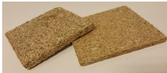
Figure 2. Exemples de panneaux obtenus, à base d'écorces de tournesol à gauche, d'anas de lin à droite
